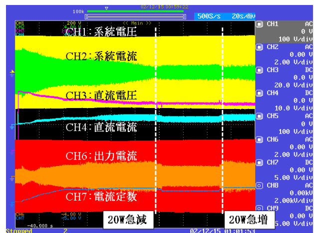
図5. 日射急変時における計測波形の振幅変化 Fig. 5 Observed waveforms at rapid irradiance fluctuation.
