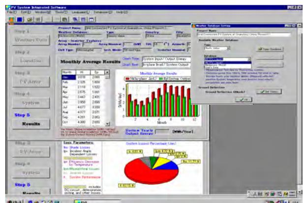
図 1 . 基本設計ツールにおける年間発電電力量及び損失パターンの算出結果
