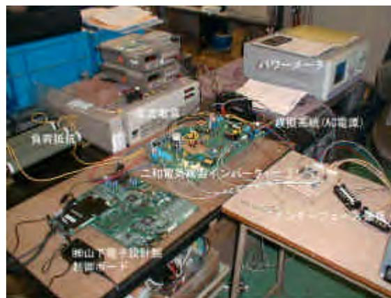
図 1: 接続試験にて構成されたプロトタイプ AC モジュール
