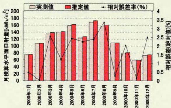
図10. 日射量の推定精度
