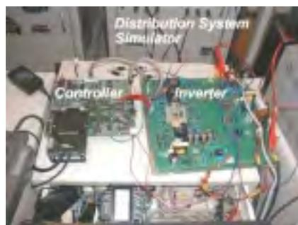
図 1: 制御ボード(Ver. 1.0)とインバータ(Ver. 3)より構成された試験システム
