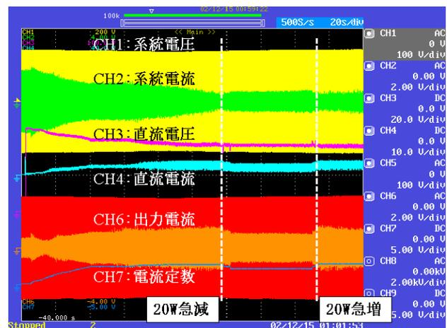
図5. 日射急変時における計測波形の振幅変化
