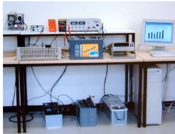
各種蓄電池のサイクル試験設備
